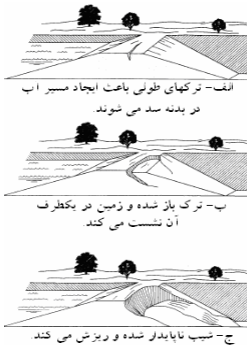
شکل شماره ۱۳ - چگونگی شکل گیری لغزش
