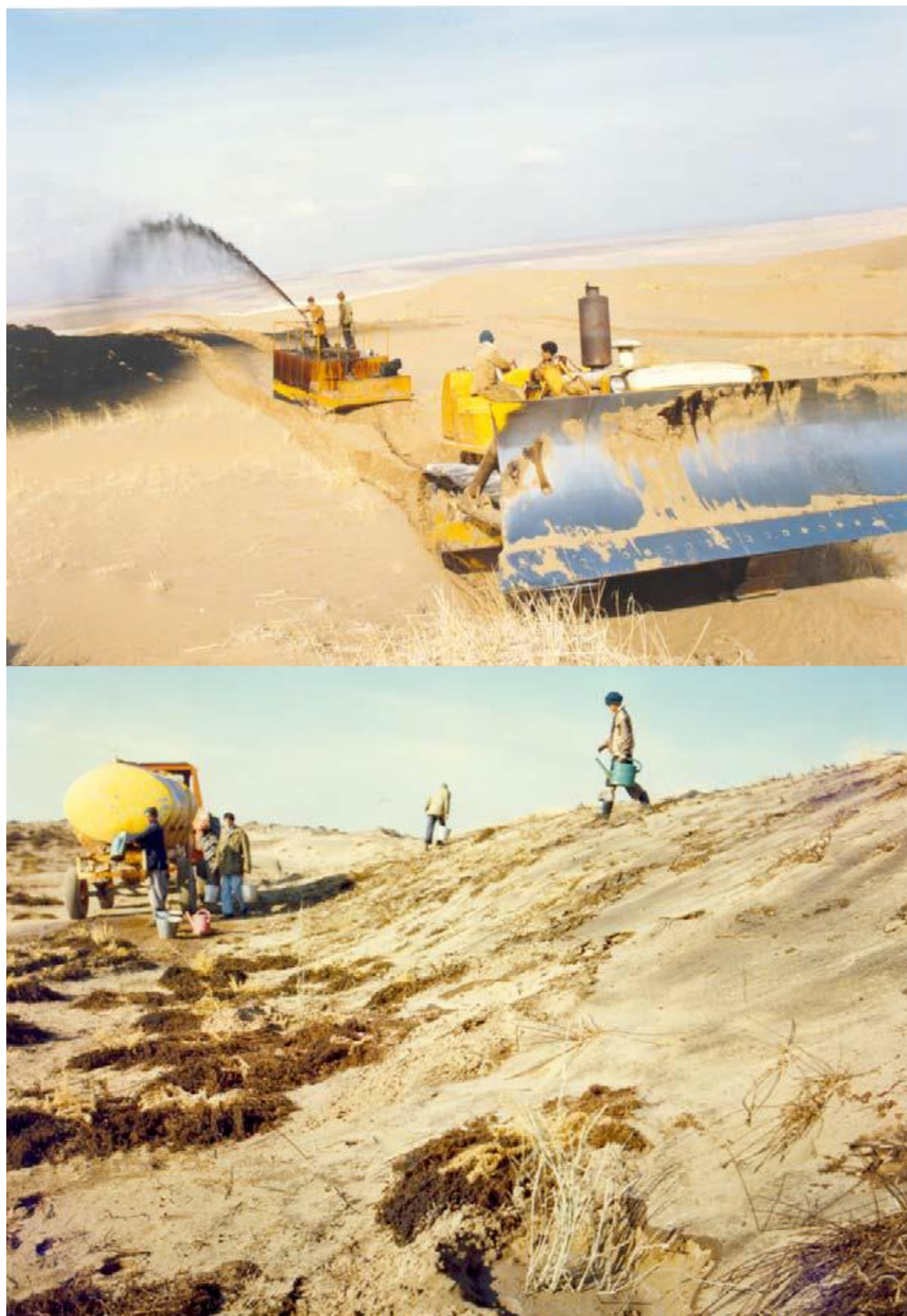
شکل ۲-۳۲- حرکت بلدوزر در یک مسیر ماسه‌ای و تسطیح آن به وسیله اسکی و مالچ پاشی بر روی آن (شکل بالا) می‌تواند سبب ایجاد مسیرهایی شود که بعداً جهت آبیاری نهال‌ها، مورد استفاده قرار گیرد (شکل پایین).
