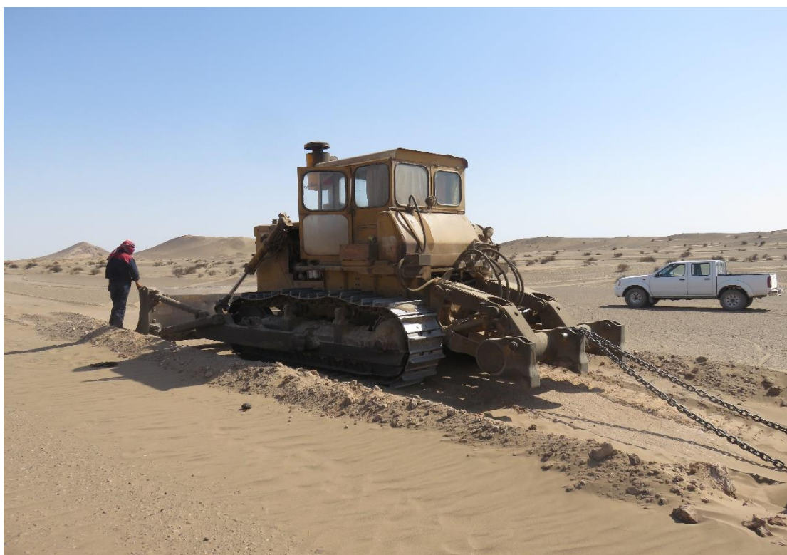
شکل ۲-۲- بولدوزر مجهز به وینچ برای کشیدن اسکی
