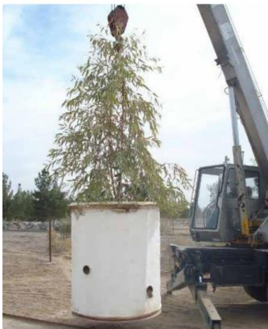
شکل ۲-۳- نمایی از لایسمتر وزنی زهکش دار سایت تحقیقاتی آزمایش‌های الیسمتری ایستگاه تحقیقات بیابان‌زدایی شهید صدوقی یزد (راد، ۱۳۹۷)
