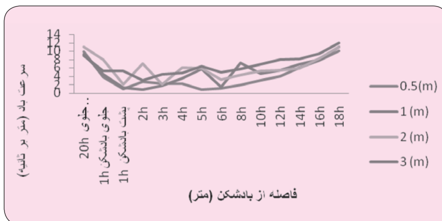
شکل شماره ۱- نمودار تغییرات طولی و ارتفاعی سرعت باد در اطراف بادشکن دیوار گلی
