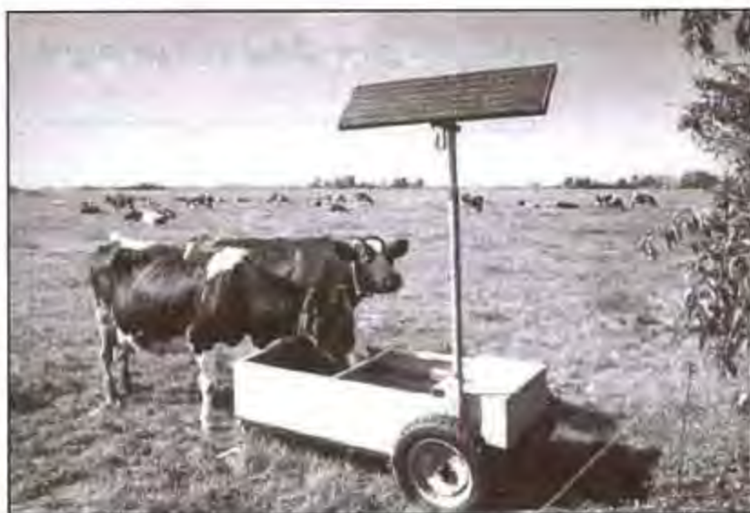
تصویر ۲: استفاده از انرژی خورشیدی برای آب آبخش‌خور دام در مراتع
