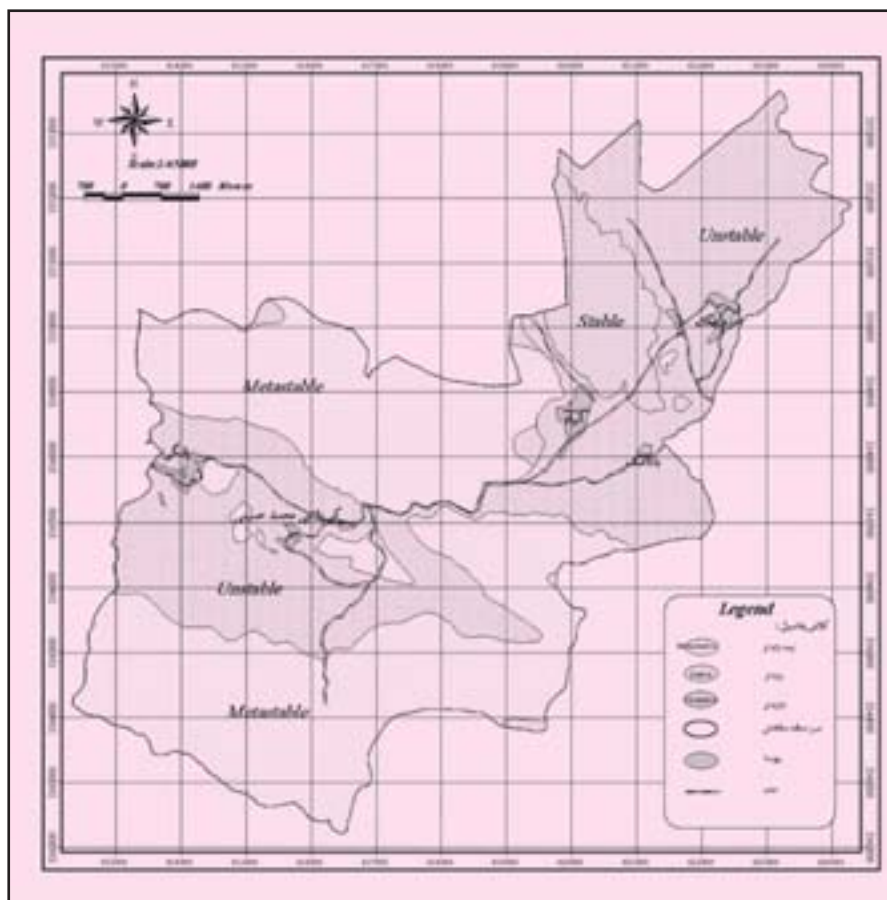
شکل شماره ۵: نقشه پتانسیل لغزش و ریزش در منطقه مطالعاتی تنگ شول
